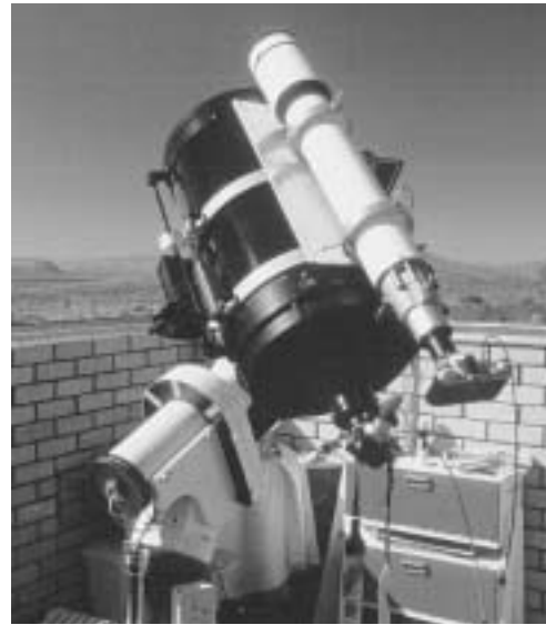
Abb. 2-17: Eine Montierung muss nicht, wie oft behauptet wird, für die Poljustage unbedingt horizontal ausgerichtet werden! Als gutes Gegenbeispiel kann die hier gezeigte Sideres-Montierung auf der Cuno Hoffmeister Gedächtnissternwarte in Windhoek/Namibia dienen. Sie ist trotz ihrer Verkipfung um fast 20^\circ gegenüber dem Horizont so genau mit Hilfe der Scheiner-Methode auf den Himmelspol justiert worden, dass selbst bei Belichtungszeiten von 60 Minuten bei einer Brennweite von mehr als 2400mm nur minimale Korrekturen in der automatischen Nachführung notwendig sind.
