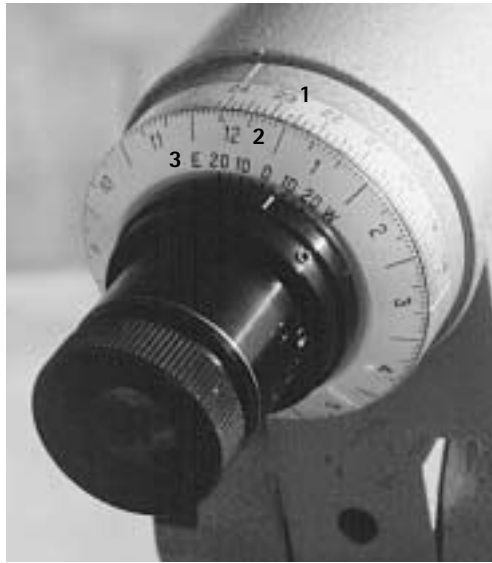
Abb. 2-16: Der Polsucher einer SuperPolaris-Montierung des japanischen Herstellers Vixen. Man erkennt die verschiedenen Skalen, an denen vor Beginn der eigentlichen Poljustage die Zonenzeit (1) mit dem aktuellen Datum (2) in Übereinstimmung gebracht werden müssen. Zuvor ist noch die Differenz der geographischen Länge des Beobachtungsortes zum sog. Zeitmeridian einzustellen (3). In der Abbildung ist diese Einstellung für \lambda \cong 7^\circ Ost (also ca. 8^\circ westlich des 15^\circ Längengrades, an dem die bei uns gültige MEZ gemessen wird) für den 10. Januar um 22:00 Uhr gezeigt! Hierbei ist besonders auf die Korrektur einer eventuellen Sommerzeit zu achten.
