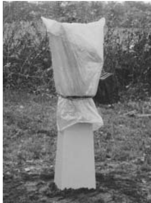
Abb. 2-19: Will oder kann man keinen richtigen Schutzbau für das Teleskop bauen, besteht die Möglichkeit die auf der Säule verbleibende Montierung mit einer Plane vor Wettereinflüssen zu schützen. Zur Beobachtung wird nur noch das eigentliche Teleskop aufgesetzt.
