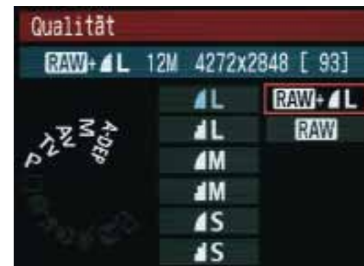
Einstellung der Bildqualität bei einer Canon EOS 450D: Gewählt ist hier das RAW-Format, während das Foto gleichzeitig auch im JPG-Format in der besten Qualität (L für „Large“) gespeichert wird.
